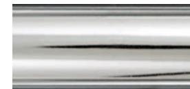
\* La prueba consiste en aplicar un paño de algodón empapado del producto sobre la superficie. Tales productos se cubren con un cristal de diámetro suficiente y todo se deja en ambiente normal. Transcurrido el tiempo previsto, se limpia la superficie y tras 24 horas se procede al examen visual de los posibles efectos.
